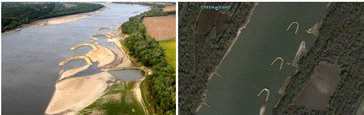
5. ábra: Chevron gátak a Mississippin folyón az Egyesült Államokban.
