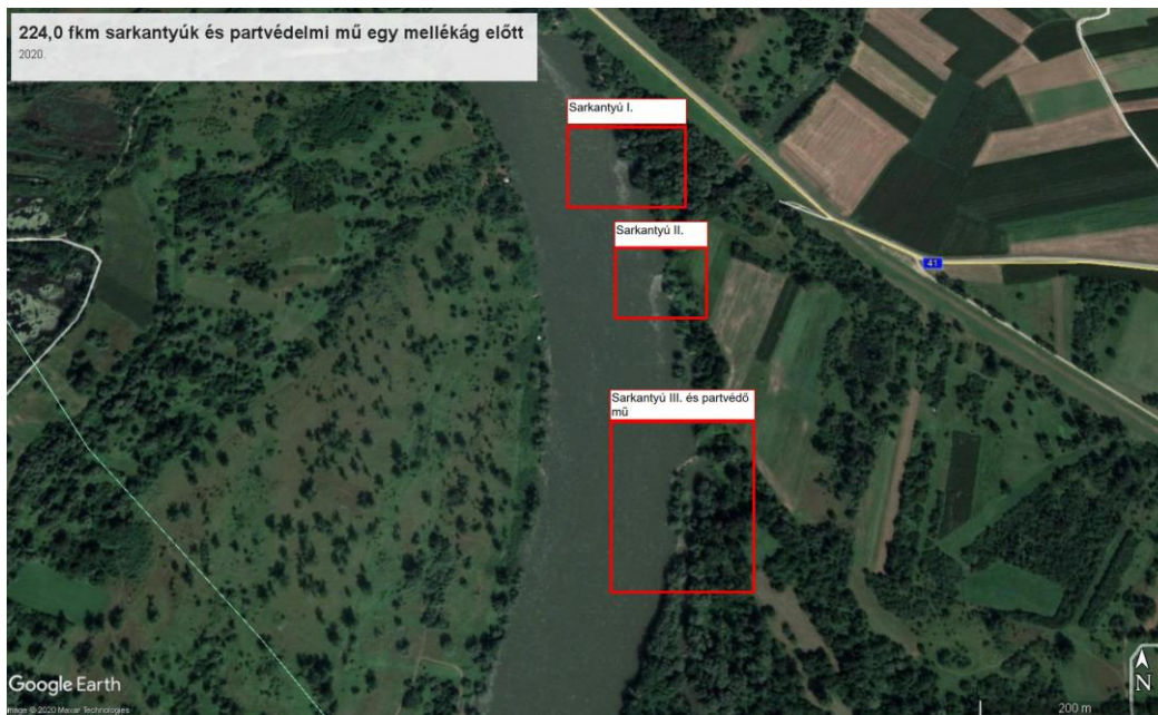
30. ábra A 224,0 fkm-nél található 3 sarkantyú és partvédő megbontása segítheti a mellékág visszacsatolását. A mellékág a III. jelű sarkantyú mögött és a partvédő mű mellett kezdődik. A III. sarkantyú a mellékág szájja előtt húzódik keresztbe.
